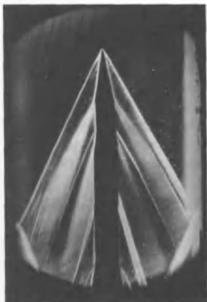
Шлирен-фотография ударных волн, вызванных пулей в аэродинамической трубе. Фото иллюстрирует феномен, который в 1889 году в ходе экспериментов наблюдал Эрнст Мах. (В его честь скорость звука получила название Мах-1.) Технику шлирен-фотографии впервые применил Август Топлер в 1864 году для «наблюдения» за звуковыми волнами
